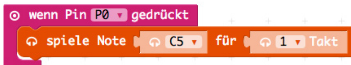
Abb. 3–8 Programmierbefehle zum Erzeugen eines Tons bei Drücken des Gegenstandes an Pin P0
